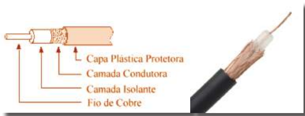
Fig. 12: Camadas do cabo coaxial
